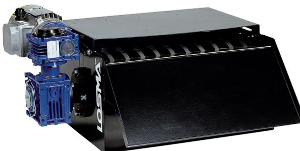
A DEMAG sorozatú hűtőfolyadék szűrők 7 alapmodellje a mágneses tárcsáival képes szűrni a modelttől függően olajemulziónál 50-400 l/perc és tiszta olajnál 25-200 l/perc szűrőteljesítménnyel.
