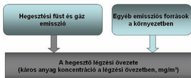
H22-7. ábra. A hegesztő légzési övezetének szennyező forrásai
